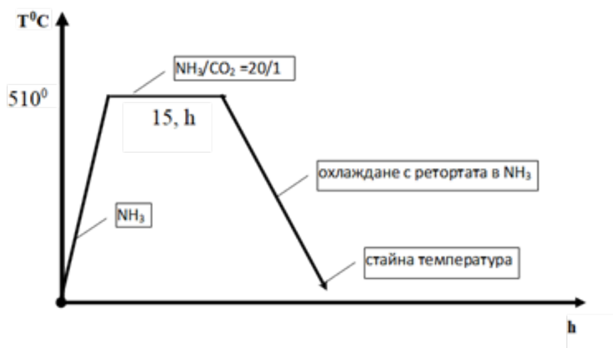
Фигура 2. Циклограма на технологичния процес
