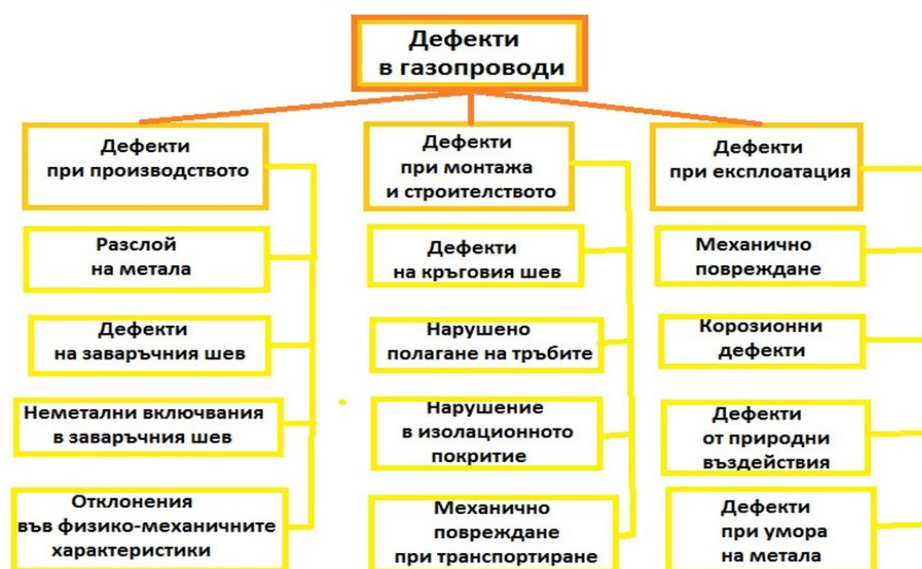
Фиг.1. Видове несъвършенства и отклонения в газопроводи.
