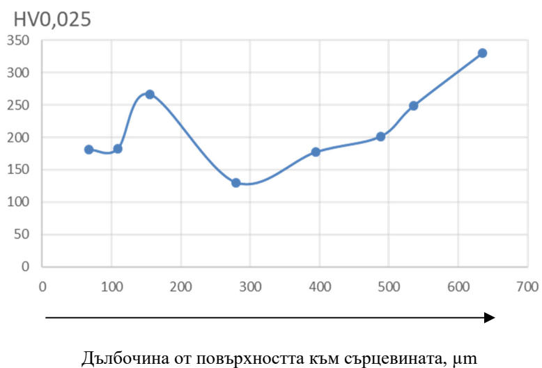
Фигура 7. Разпределение на микротвърдост на образец от AlZn10Si8Mg от повърхността към сърцевината на сплавта след НТГКН
