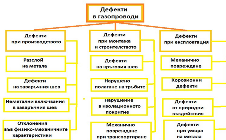
Фиг.1. Видове несъвършенства и отклонения в газопроводи.
