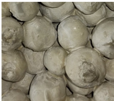
Фиг. 2. Структура на експериментален образец (фрагмент), получен чрез прилагане на частично свободно оттичане на течната фаза.
