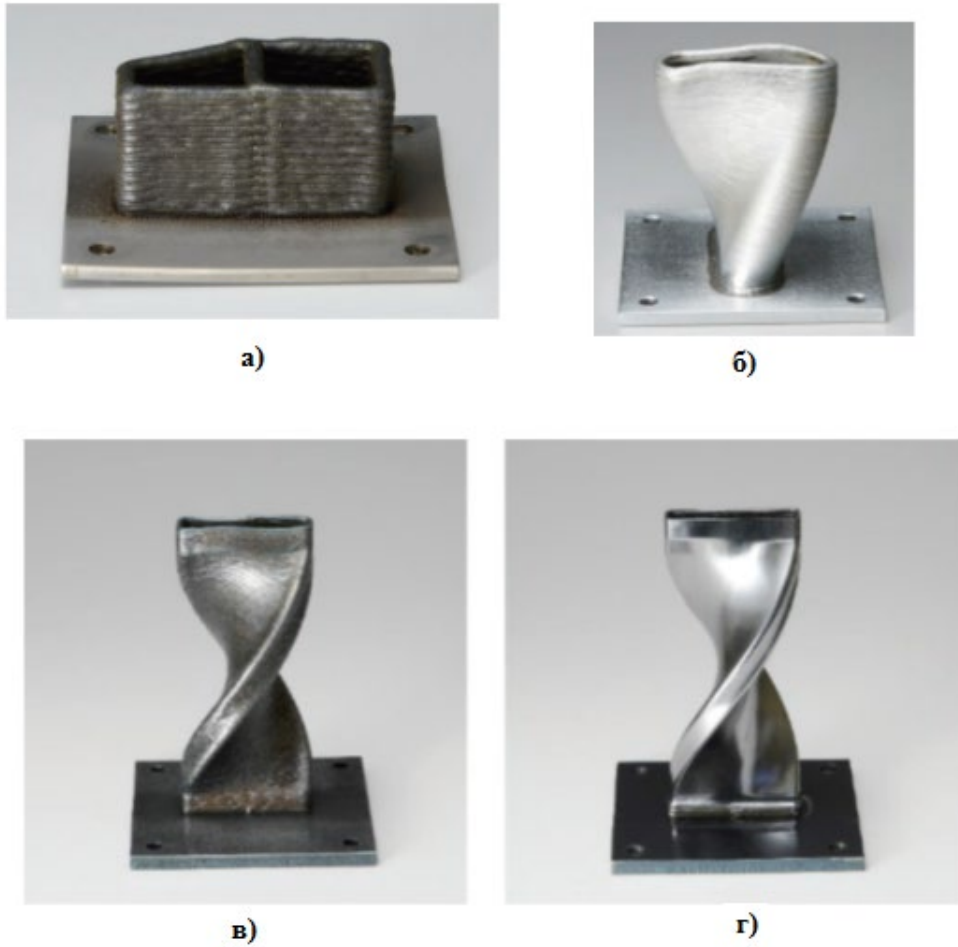
Фиг. 3. Триизмерни детайли, получени чрез електродъгова технология с 3D-принтера Value Arc MA5000-S1 (Япония) [23]: детайли от въглеродна стомана (а), алуминий (б) и титан (в) без механично обработване; детайл от титан след механично обработване (г).
