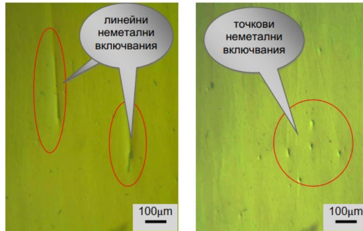
Фигура 6. Микроструктура на неразядена проба – увеличение X 100
