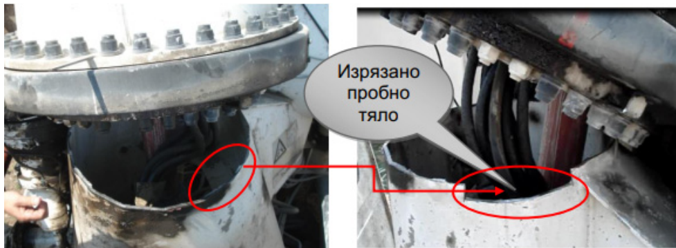
Фигура 3. Зона на изрязване на пробното тяло свидетел
