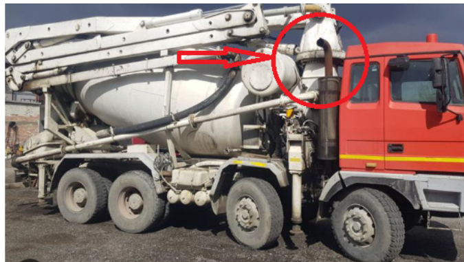
Фигура 2. Местоположение на „петото колело“ на автобетон помпата
