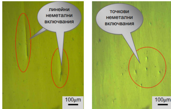
Фигура 6. Микроструктура на неразядена проба – увеличение X 100
