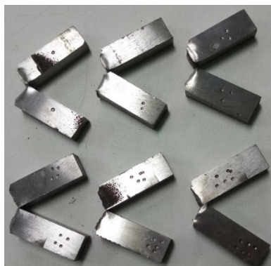
Фиг.4 Пробни тела след изпитване на ударна жилавост
