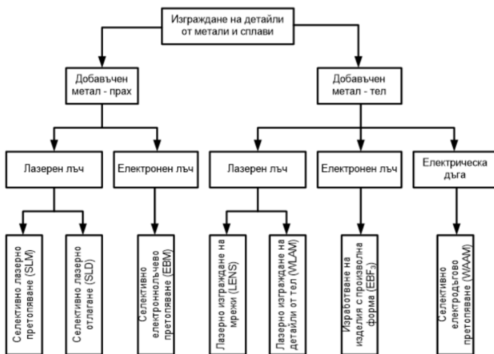
Фиг. 1. Класификация на методите за изграждане на детайли от метали и сплави.
