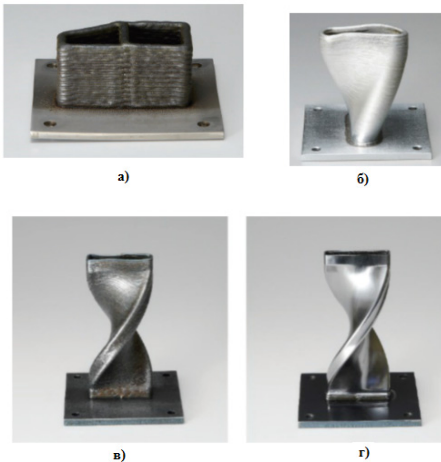
Фиг. 3. Триизмерни детайли, получени чрез електродъгова технология с 3D-принтера Value Arc MA5000-S1 (Япония) [23]: детайли от въглеродна стомана (а), алуминий (б) и титан (в) без механично обработване; детайл от титан след механично обработване (г).
