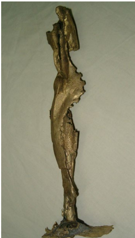
Фиг. 4. Сложнорелефна отливка, при която модела е обмазан с графитна противопопригарна обmazка и свързващо вещество карбофенова смола
