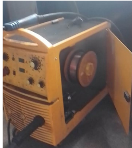
Фигура 1. Схема и общ вид на оборудване за МАГ (MAG) наваряване
