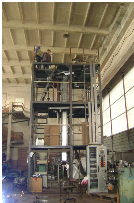
Фиг. 8. Реално изработена и експериментирана вертикална печ за пеностъклените непрекъснати ленти
