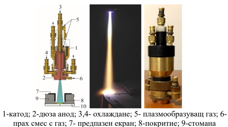
Фигура 4. Плазмено прахово напластяване
