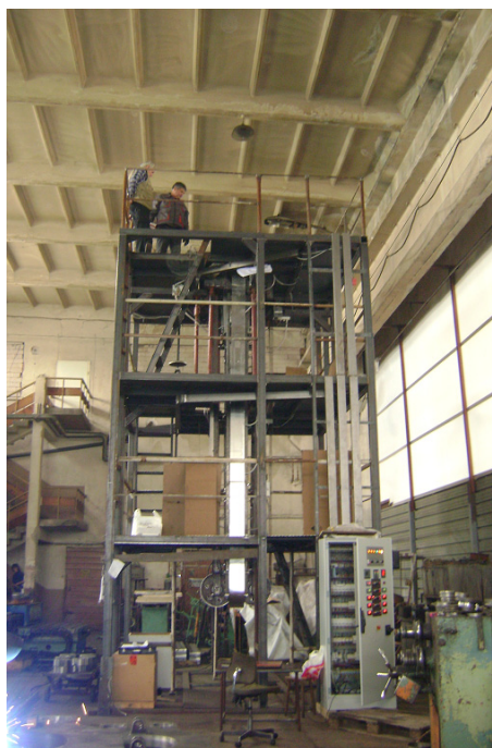
Фиг. 8. Реално изработена и експериментирана вертикална пещ за пеностъклените непрекъснати ленти
