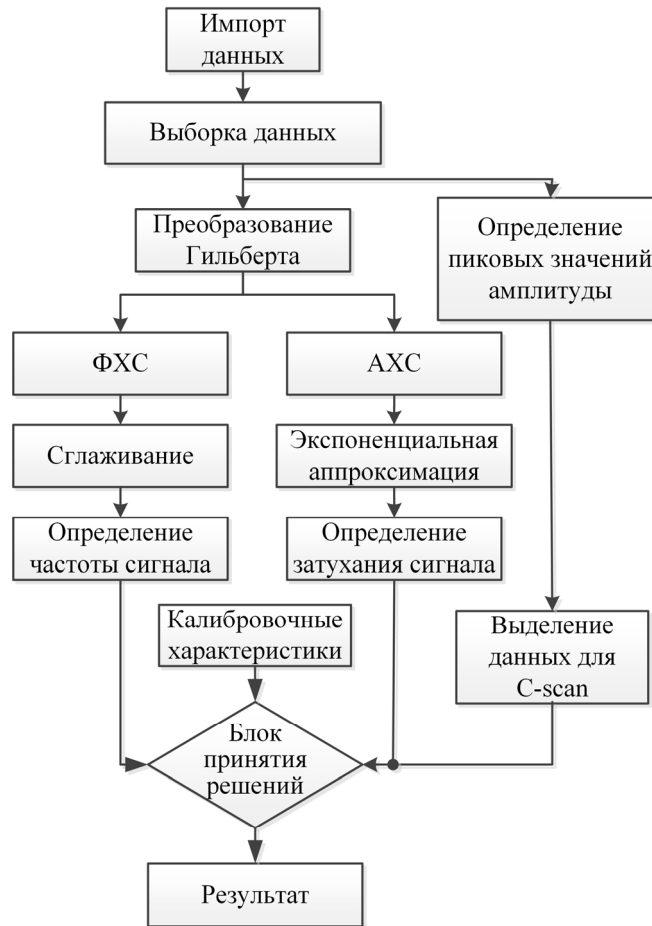
Рис. 1. Методика обработки сигналов ВТП
