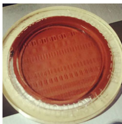
Фигура 6. Визуализиране на магнитно поле с т.нар. магнитна лупа
