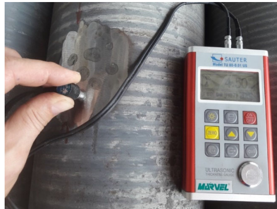
Фиг. 7. Контрол на дебелината на стена.
