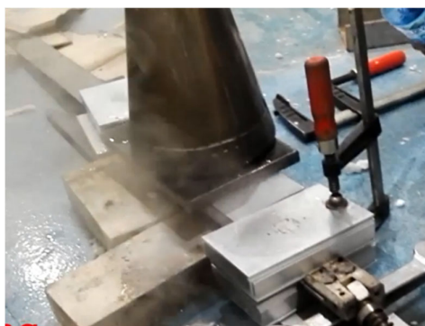
Фигура 5 Охлаждане след пламъчно закаляване.
