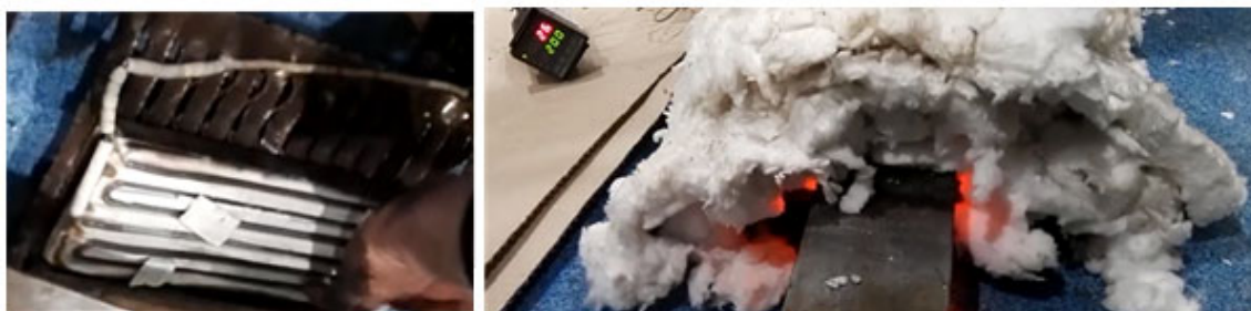
Фигура 6 Нискотемпературно отвърщане на 200^{\circ}\text{C}
