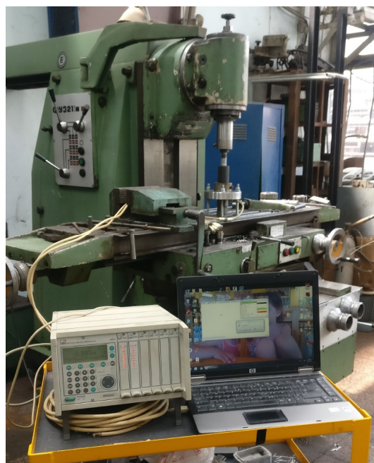
Фиг. 5 Тензометрична измервателна апаратура MGCPlus в процес на измерване
