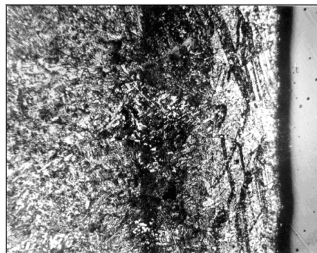
Фиг.4. Микроструктура след йонно азотиране
