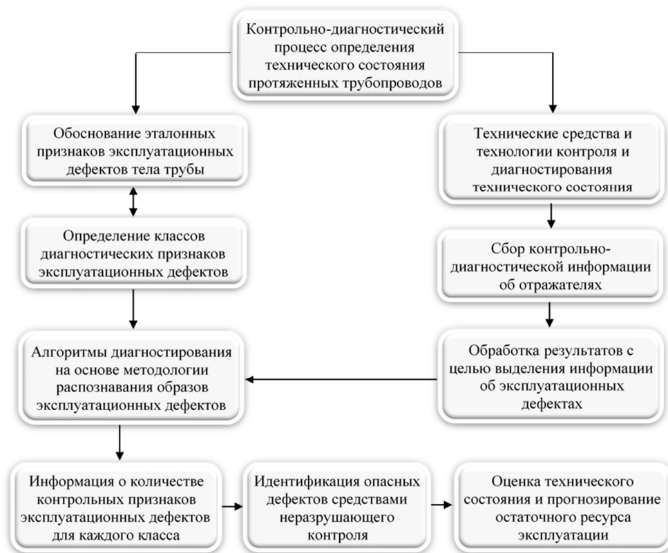
Рис. 2. Структурная схема контрольно-диагностического процесса определения технического состояния протяженных трубопроводов
