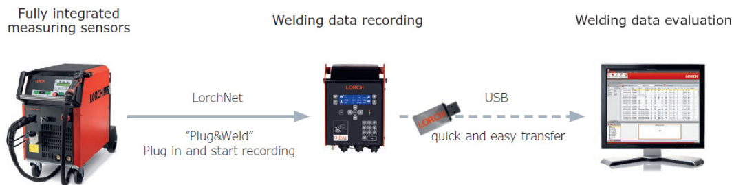
Фиг. 3 – Система, при която обменът на данни става посредством външна USB памет[29]
