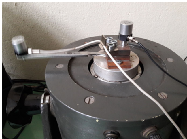
Фигура 2 Експериментална установка на вибромаса за изпитанията на умора.
