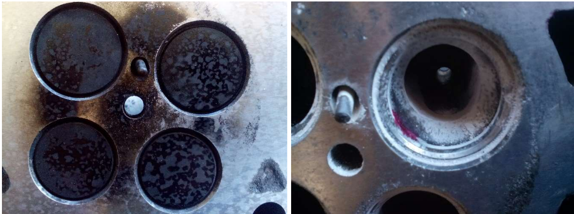
Фигура 2. Цилиндрова глава на Audi A8 след възстановяване, монтаж и последващ капилярн контрол
