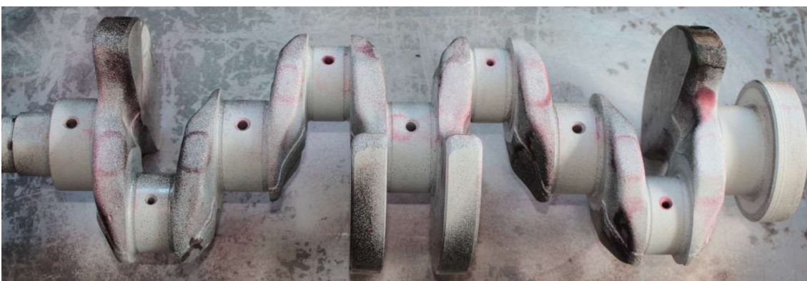
Фигура 4. Капиларен контрол на колян вал
