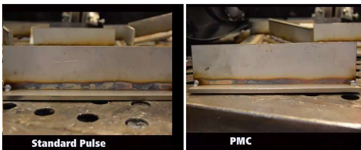
Фигура 4. Заваръчен шев изпълнен с помощта на функциите PULSE и PULSE MULTI CONTROL
