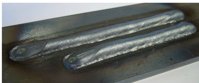
Фигура 1. Заваръчни шевове изпълнени с и без помощта на функцията HI DEPOSIT PULSE
