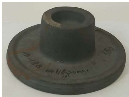
Фигура 3. Изковка на изследвано зъбно колело от стомана 45.
