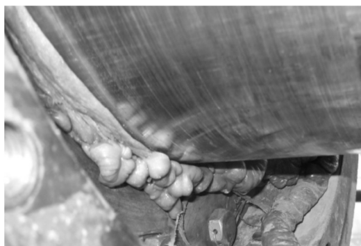
Фиг. 4. Разтопяване на лагерната втулка в следствие на влошено охлаждане и развитие на висока температура в контактния слой ( t > 250^{\circ}\text{C} ) [1]
