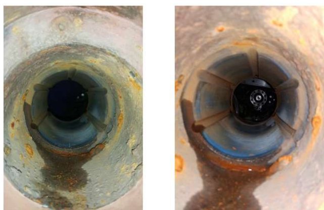
Фиг. 7. Износване в дейдвудния лагер
