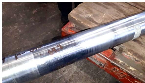
Фиг. 12. Износване на шийката на вала
