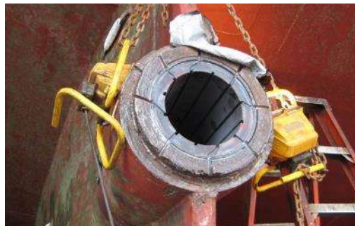
Фиг. 1. Напречно сечение на полимерна лагерна втулка.
