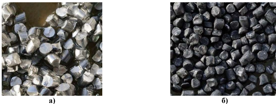
Фиг.2. Насечки от АМг5: а) преди обработка; б) след обработка с наномодификатор TiCN [2]
