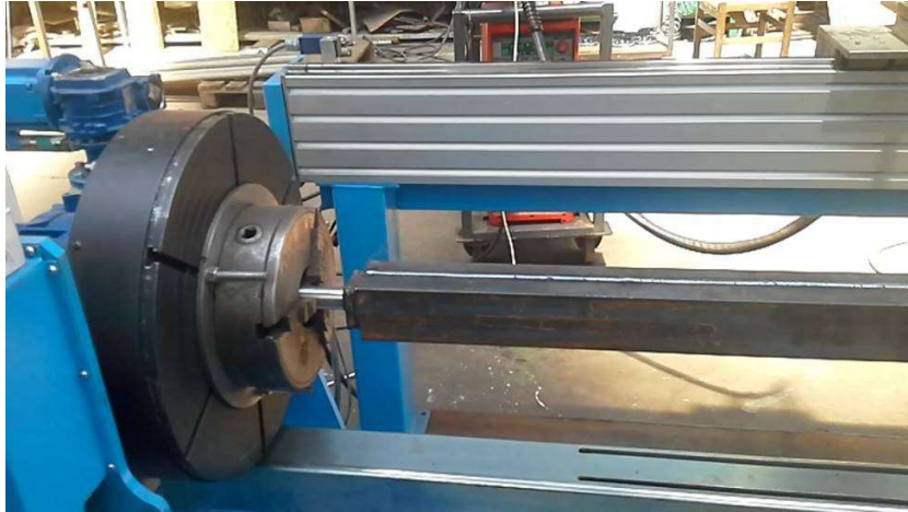
Фиг. 10. Заваряване с непрекъснат шев на греда съставена от два П-образни профила.
