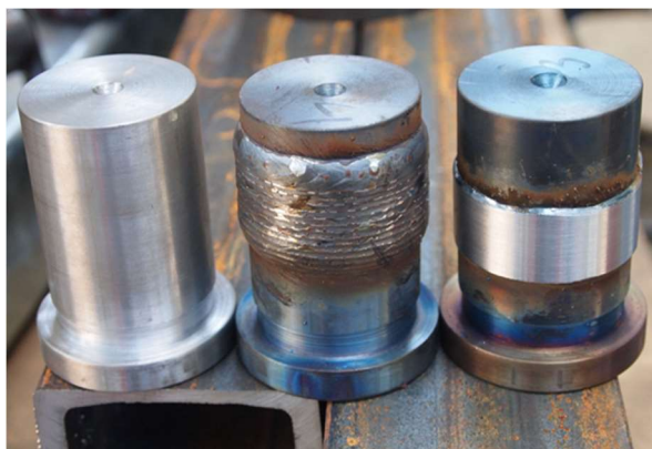
Фиг. 7. Възстановяване на износени детайли чрез предлаганата система
