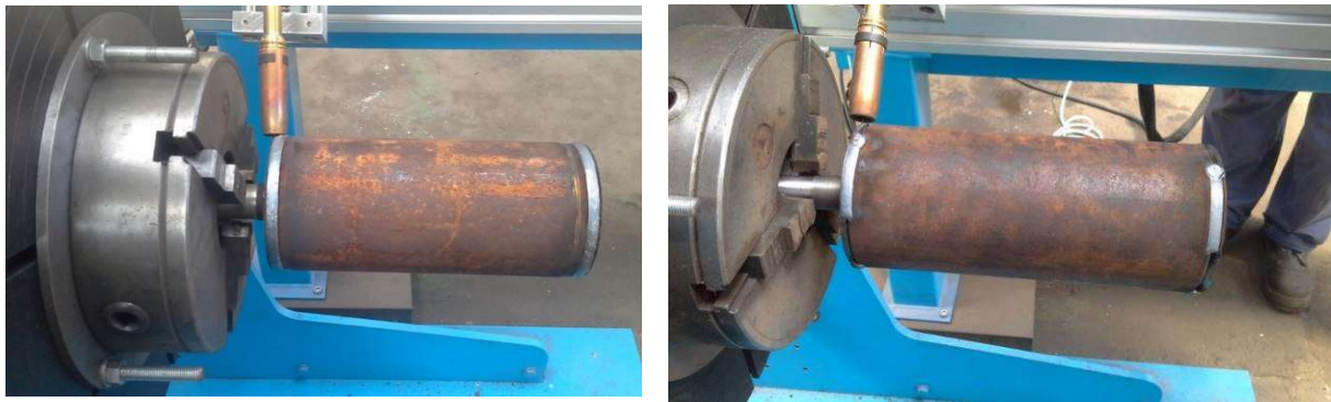
Фиг.11. Заваряване на кръгов непрекъснат и прекъснат шев – две тапи към тръба.
