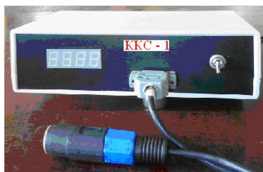
Рис. 3. Аппаратура для контроля электротехнических изделий с малой к коэрцитивной силы
