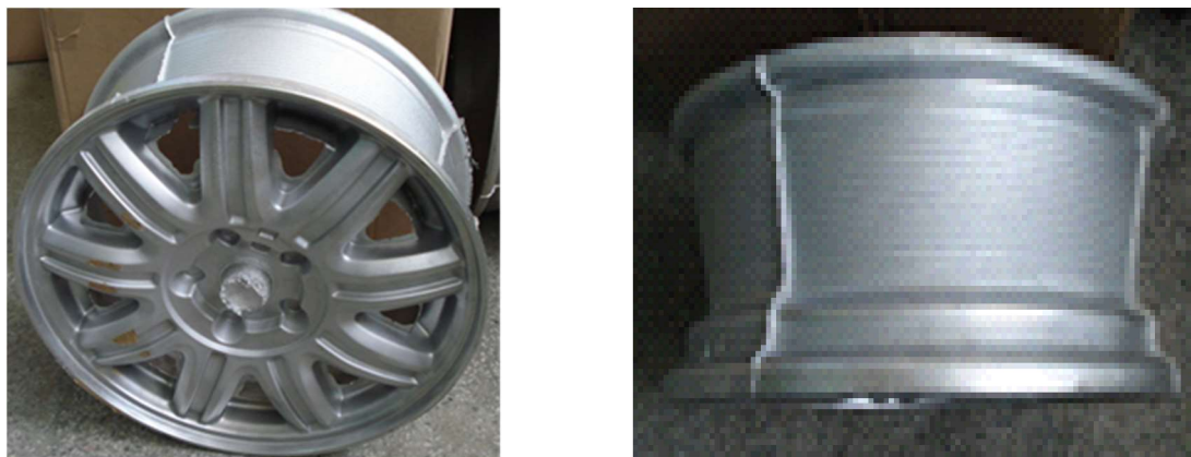
Фиг. 1. Снимки на лята алуминиева джанта от сплав AlSi7Mg
