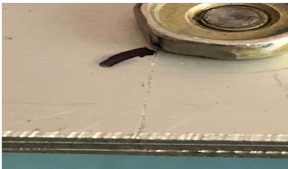
Рисунок 3. Фото части образца соединения деталей при помощи заклёпок с видимой трещиной
