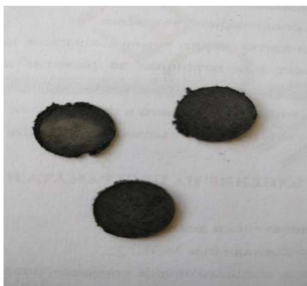
Фиг. 2. Тестови електроди от АЕМ тип NMC подготвени за измерване на магнитното шумово напрежение E_{NB}
