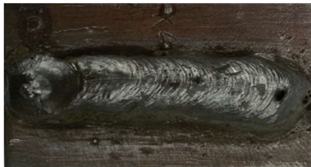
Фиг. 2. Планка от стомана S 235 с дебелина 10mm наварена на три слоя
