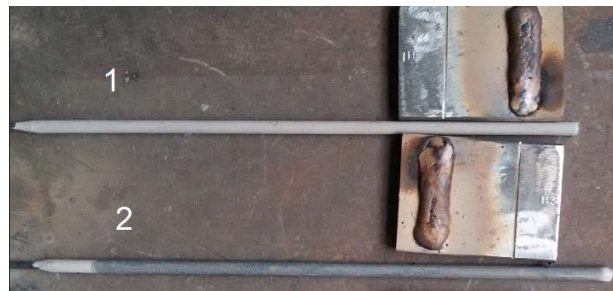
Фиг. 1. Базова проба E300 (1) и проба, потопена само във водно стъкло VB (2)
