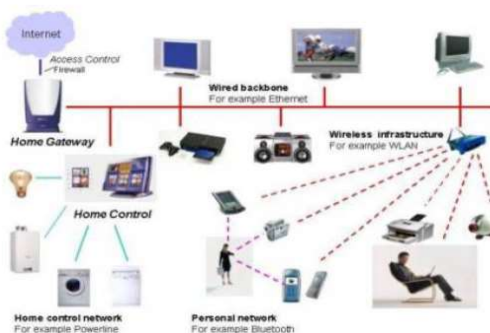
Фиг. 1. Комуникационна мрежа в умнен дом [1]
